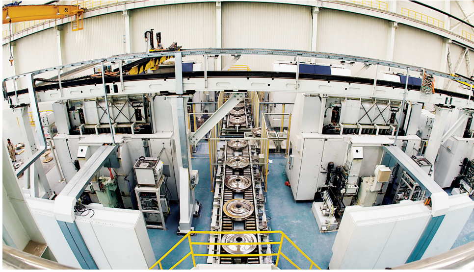
太重高速列车车轮全自动加工生产线
