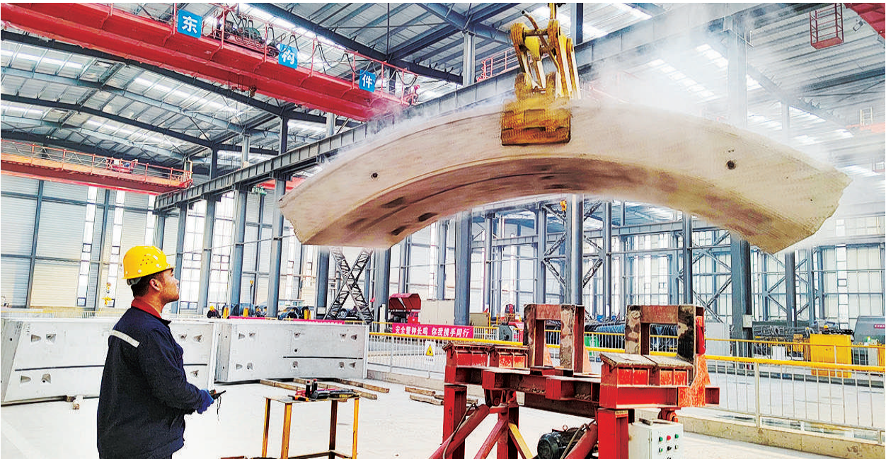
地铁水泥构件脱模起吊。
