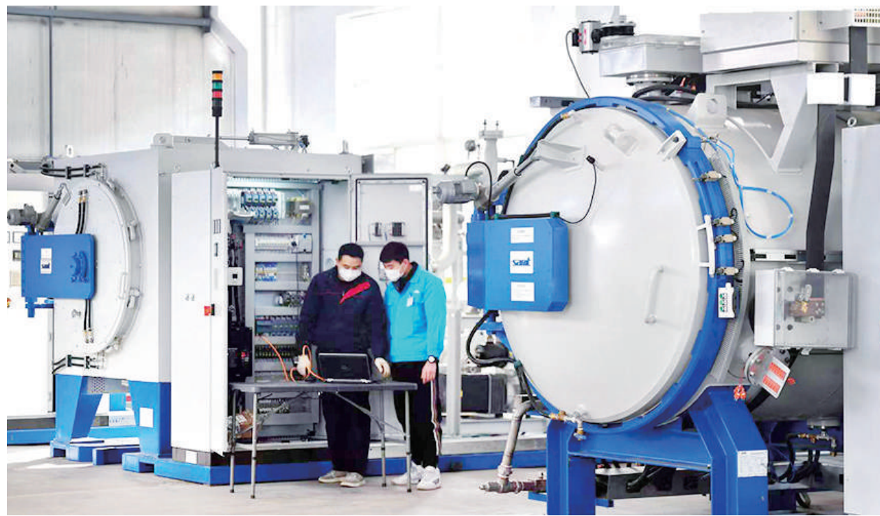
1月3日,太原工具厂有限公司,工人正在对华北地区先进的高速钢热处理生产线进行最后的调试,以保证本月中旬投入使用。 韩双喜 李学军 摄
