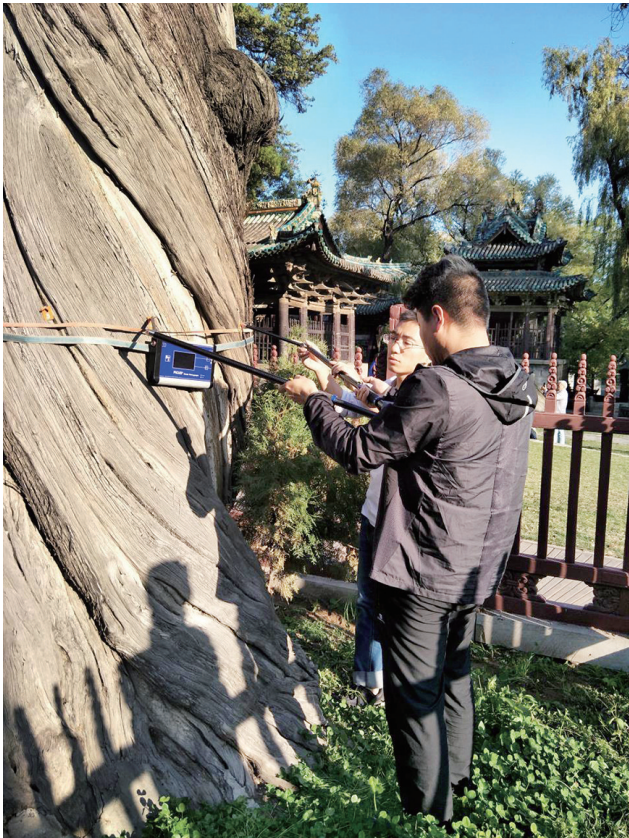
市文物保护研究院技术人员正在无损检测千年古树树干的空腐情况。
