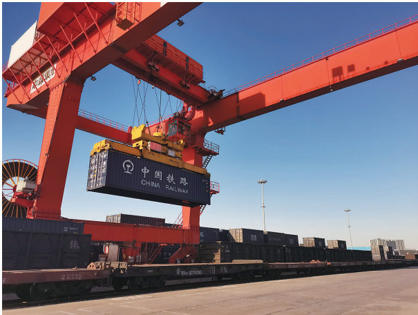
图为龙门吊在园区铁路港进行集装箱吊装。
