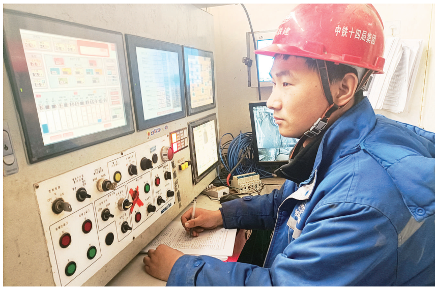
图为毛新安在地下17米的盾构机主控室内工作。
