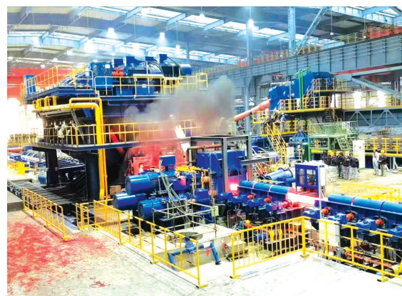
△Φ258无缝钢管智能化连轧生产线
