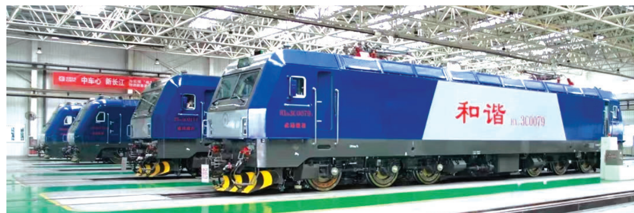
△中车太原公司和谐电力机车C6修竣工产品正在进行低压调试
