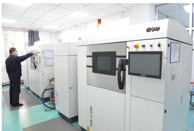
△省内唯一可加工高温合金产品的3D打印设备
