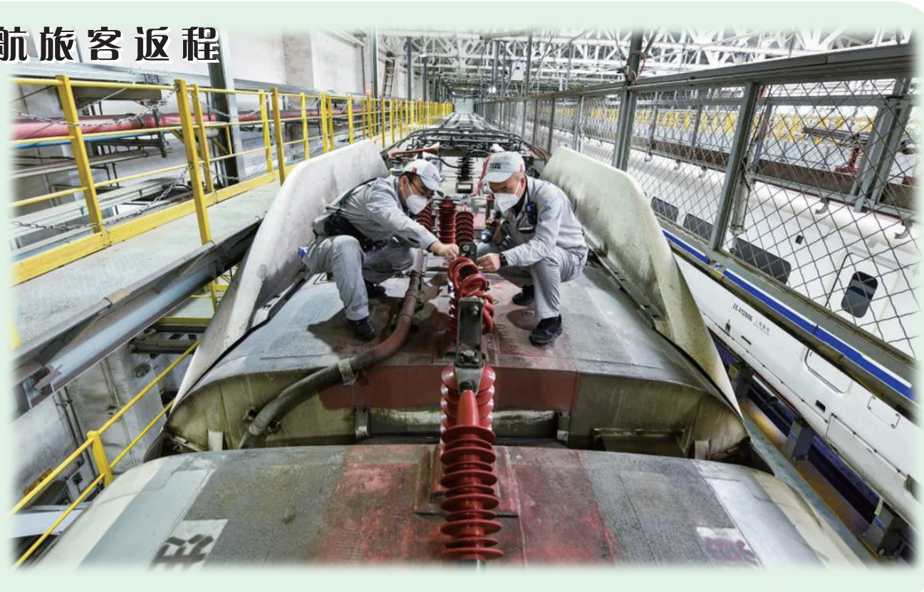
图为太原动车所的地勤机械师对车钩装置进行检查。
