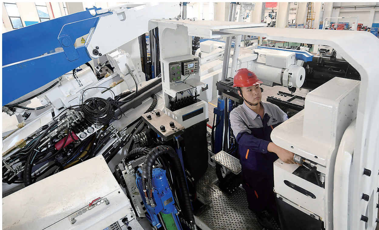
4月4日,中国煤炭科工集团太原研究院车间,员工正在为自主研发的智能掘进设备做出厂调试。该设备融合了大数据、云计算、物联网等高新技术,实现减员增效,引领了国内煤矿掘进技术与装备的发展方向。 邓寅明 摄
