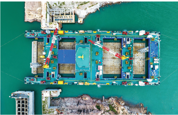
“一航津安1”号沉管运输安装一体船拖带E23管节和最终接头从珠海桂山岛启航,前往沉放水域(6月8日摄,无人机照片)。
