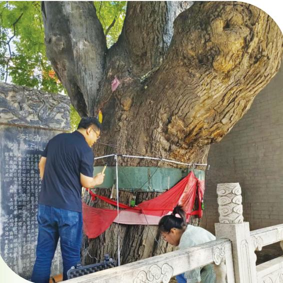
为进一步了解我市古树名木的“身体”健康状况，近段时间，市园林科创服务中心开展了“太原地区古树立地环境及树体健康诊断技术”课题研究，先后完成了30棵古树的生长环境土壤化验检测工作，并对18棵一级古树进行健康诊断。图为工作人员利用应力波无损伤探测仪对呼延村的一株500余年的国槐进行健康诊断，以确定下一步的管护工作。记者 刘晓亮 摄
