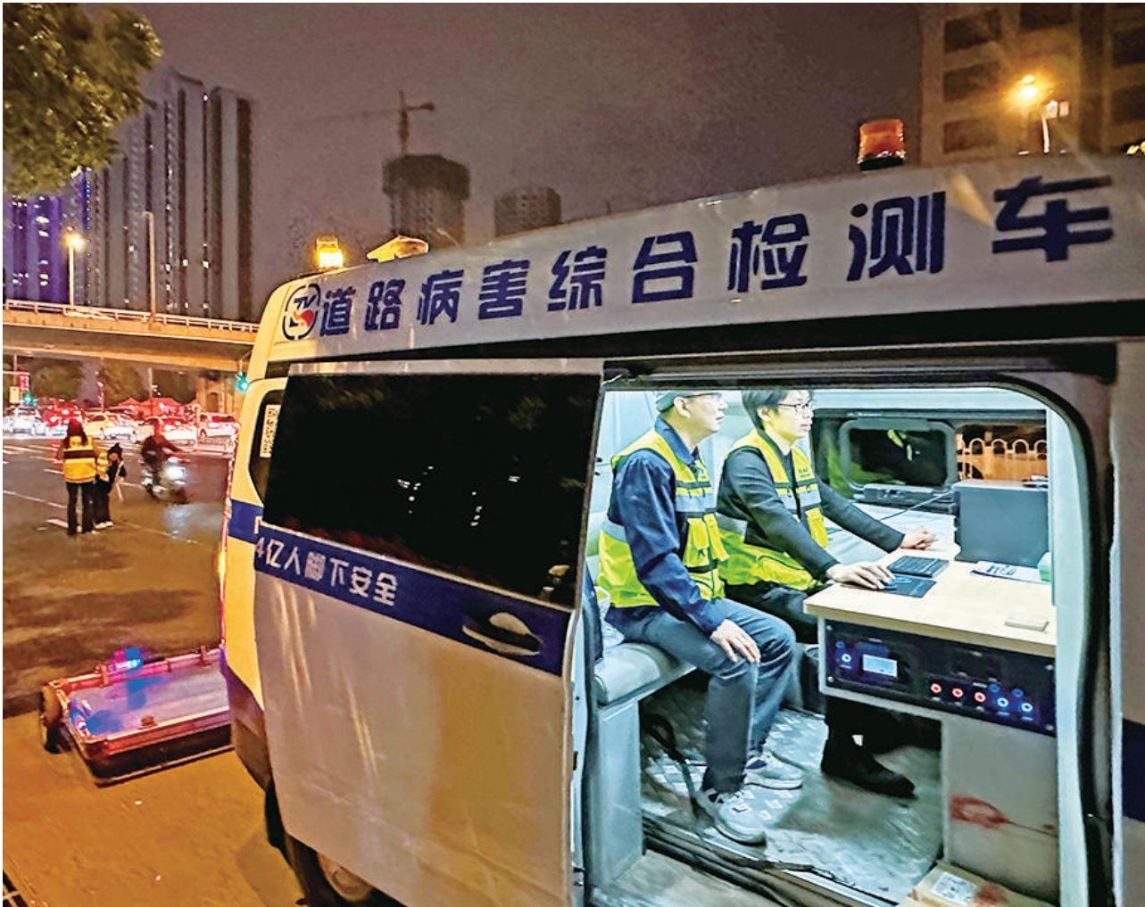
9月22日晚,太原市政建管中心市政检测站工作人员利用先进的车载三维雷达对道路进行“体检”。我市为期40天的重点道路雷达空洞探测工作全面展开,重点排查省城东山湿陷性黄土区域,及时消除道路塌陷隐患,确保市民出行安全。 牛利敏 杨 斌 摄
