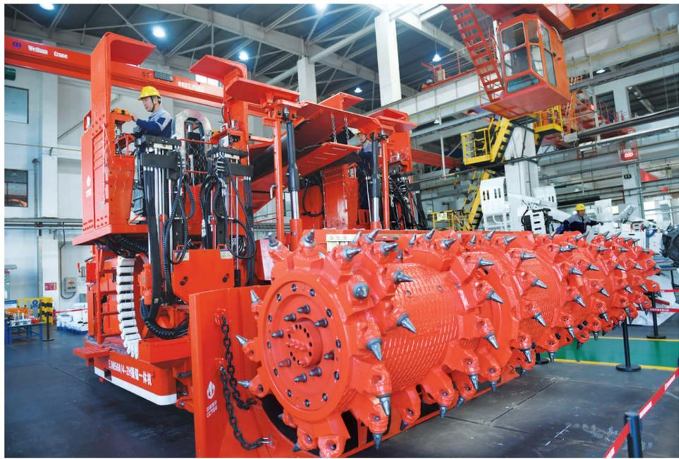
11月19日，中国煤炭科工集团太原研究院的工作人员正在为掘锚一体机出厂做调试。中国煤炭科工集团太原研究院作为山西省重点培育的高端装备制造产业链企业，坚持走“自主创新、科技引领、市场导向、产融结合”发展之路，瞄准国际前沿技术，加速科技成果转化。 邓寅明 摄
