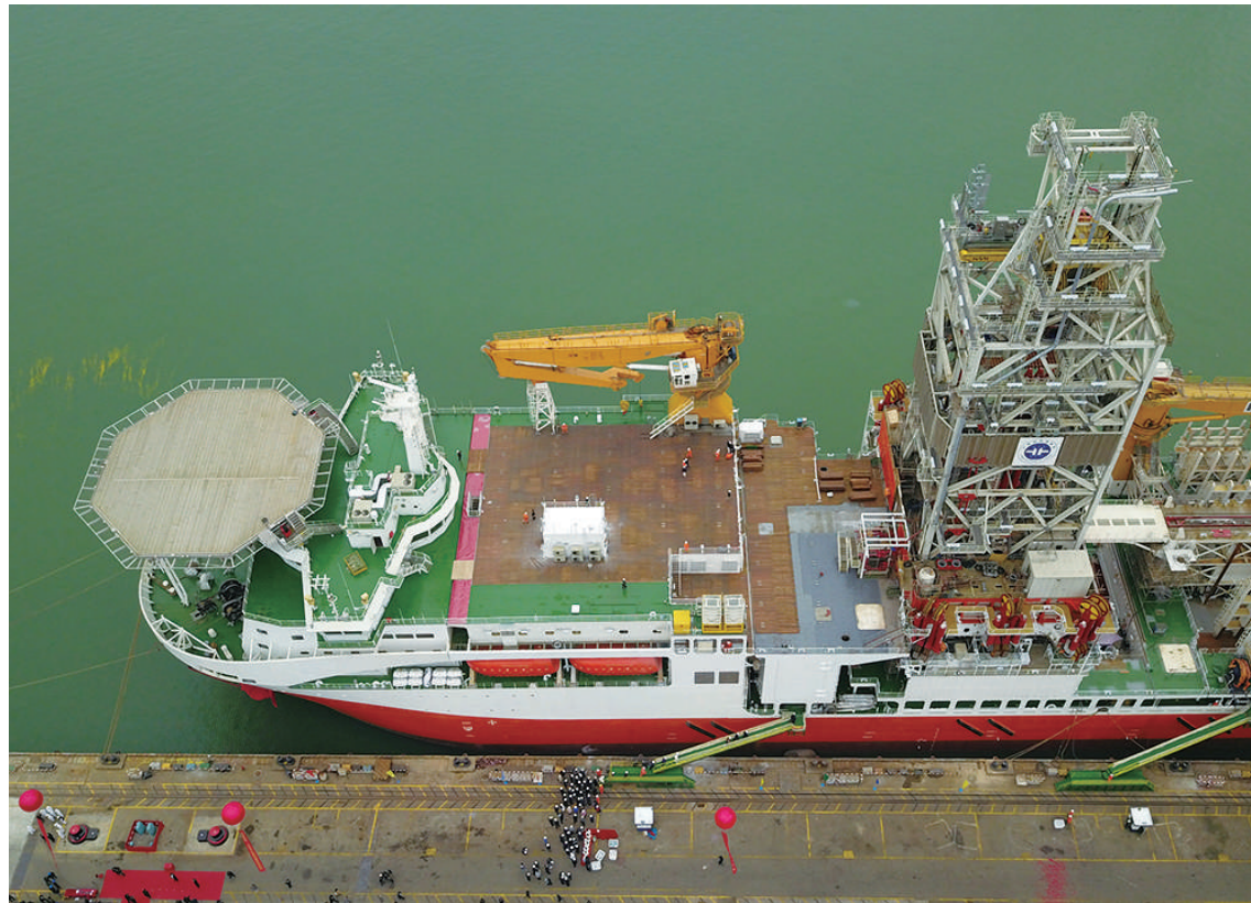
这是12月18日在广州拍摄的我国自主设计建造的首艘大洋钻探船“梦想”号(无人相机照片)。当日,我国自主设计建造的首艘大洋钻探船正式命名为“梦想”号,并在广州南沙首次试航。大洋钻探被誉为海洋科技“皇冠”。“梦想”号由自然资源部中国地质调查局与150余家单位密切协同建造,总吨约3.3万吨,续航力1.5万海里,自持力120天,具备全球海域无限航区作业和海域1.1万米钻探能力。
