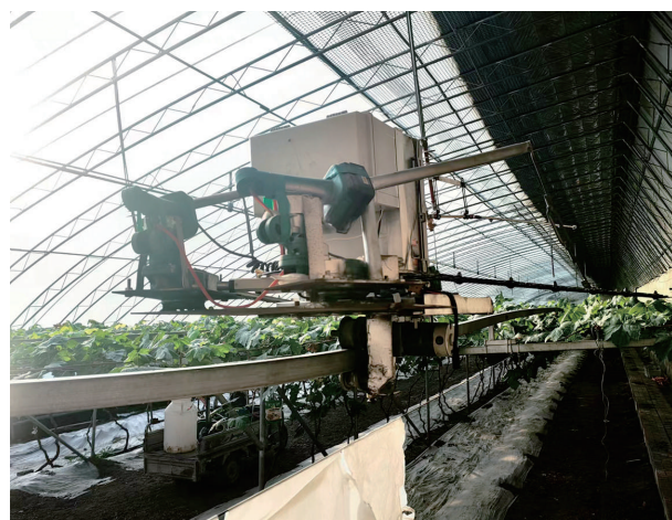
图为清徐县农业农村经济发展中心自主研发的葡萄自动剪枝修条机。
