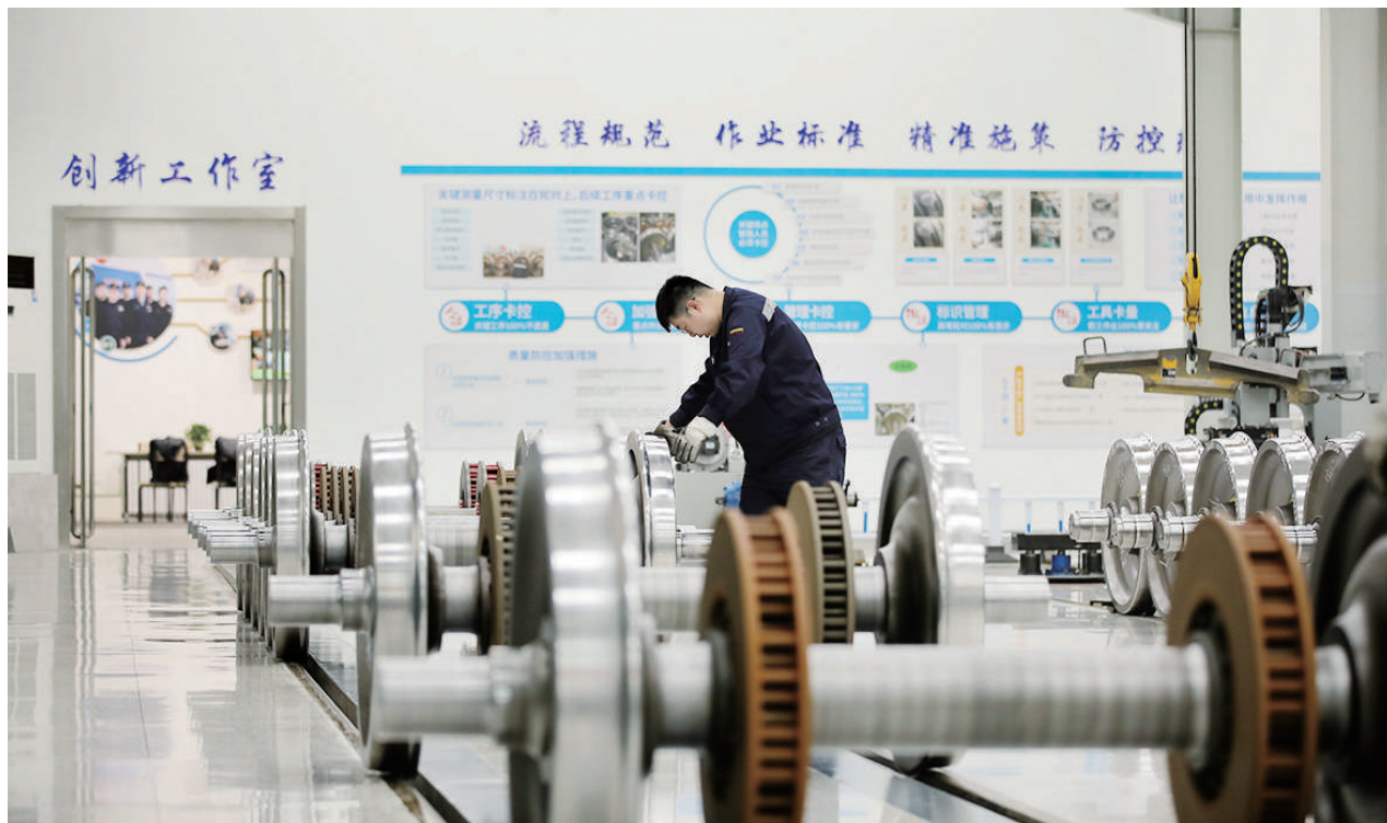
2月27日,中国铁路太原局集团有限公司太原车辆段轴轮车间“胜伟”创新工作室,工作人员正在检修客车轮轴。近期,该工作室改进轴承磨合实验获得成功,实现了解决轮对磨合异响标准化,提升了检修质量。王韵菲 摄
