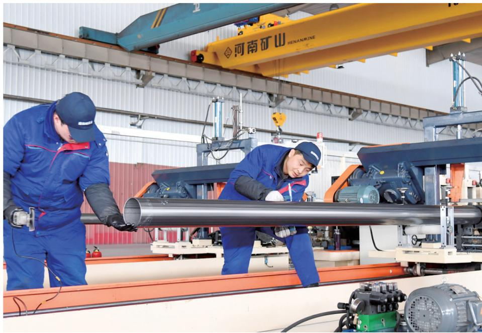
3月10日,中国宝武太钢集团不锈钢工业园的建群企业职工在生产煤矿用不锈钢托辊管。太钢持续强化产业链建设,围绕不锈钢、铸钢、中厚板等特钢材料新产品,加快补齐产业链短板,目前太钢不锈钢工业园已吸引52家企业入驻,产品涉及电力、煤矿、交通、氢能等领域,产业链建设再上台阶。王旭宏 摄
