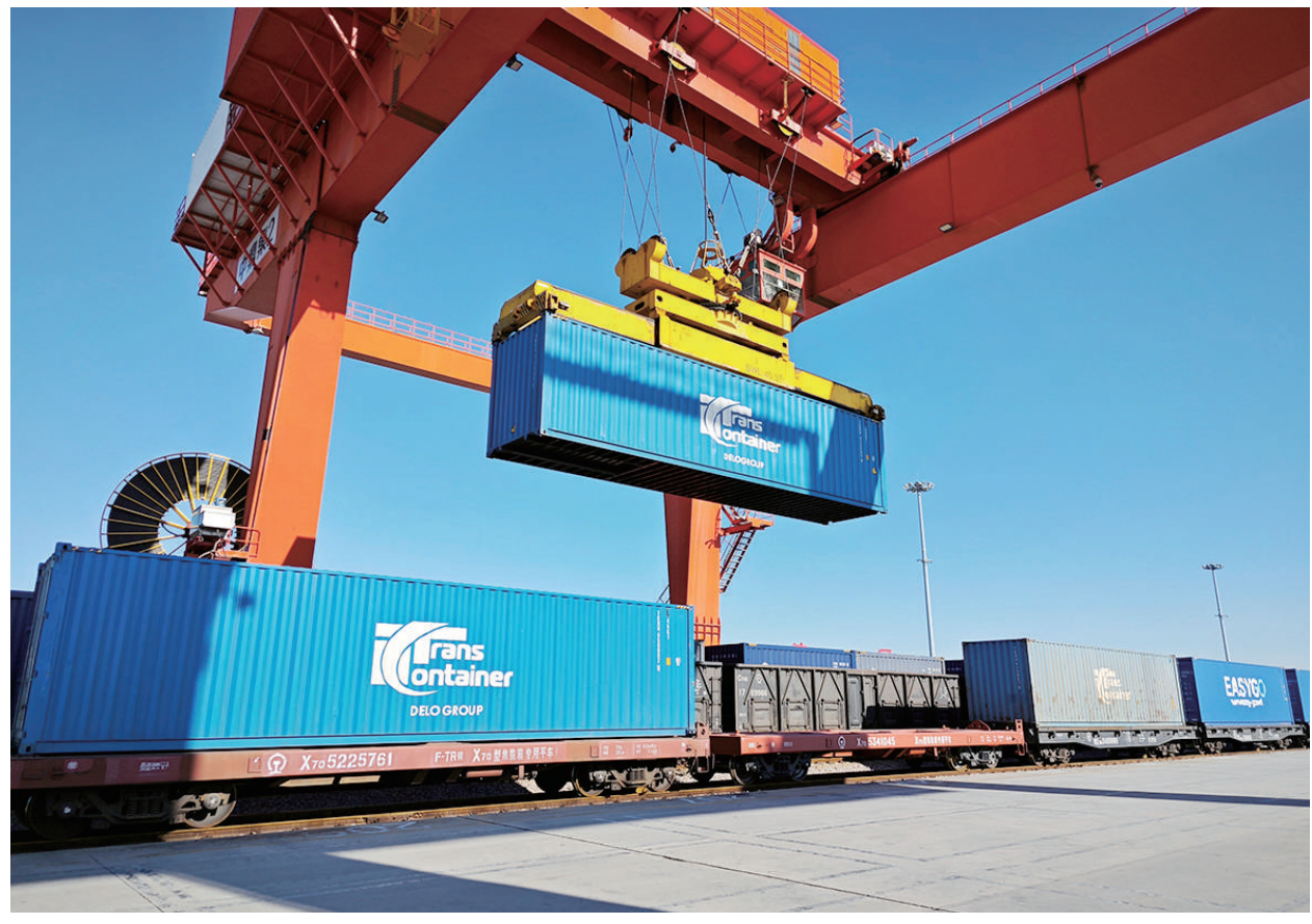
3月13日,山西转型综改示范区中鼎物流园,工作人员通过智能场站系统完成中欧班列的装卸任务。该系统主要由远程监控自动化龙门吊、集装箱无人导航车、场区管理作业调度系统三部分组成,可实现远程、无人作业,提升装车效率。牛利敏 摄
