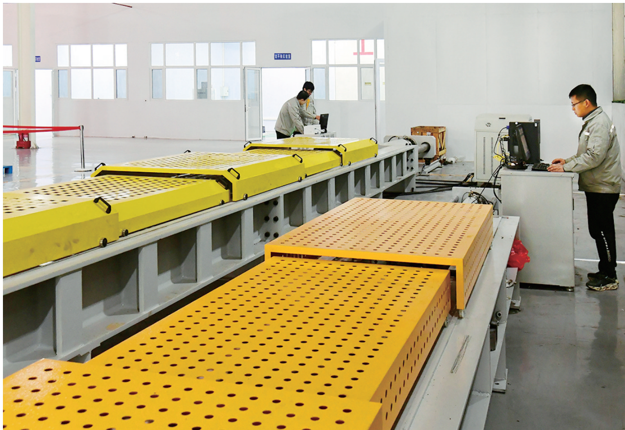
3月31日,省机电设计研究院伺服电机实验室内,技术人员正在调试永磁电机测试台。该实验室拥有电磁兼容、电机力学、环境适应等实验设备,为解决力矩电机系统关键技术、伺服电机产业化制造及我市“揭榜挂帅”重大专项提供硬支撑。
