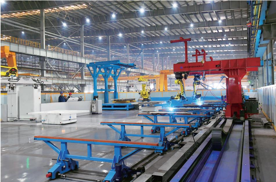
4月4日,太原锅炉集团蛇形管智能焊接工作站火花飞溅。该工作站采用国内先进的智能焊接设备应用于复杂管道焊接,工作效率和产品质量均有大幅提升。赵世凯 摄
