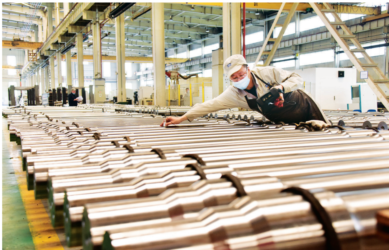
4月15日,太重集团轨道公司检验人员对车轴进行超声波探伤。该公司已形成了一套成熟的车轮、车轴研发生产技术和完善的质量保证体系,产品远销全球70多个国家。米国伟 摄
