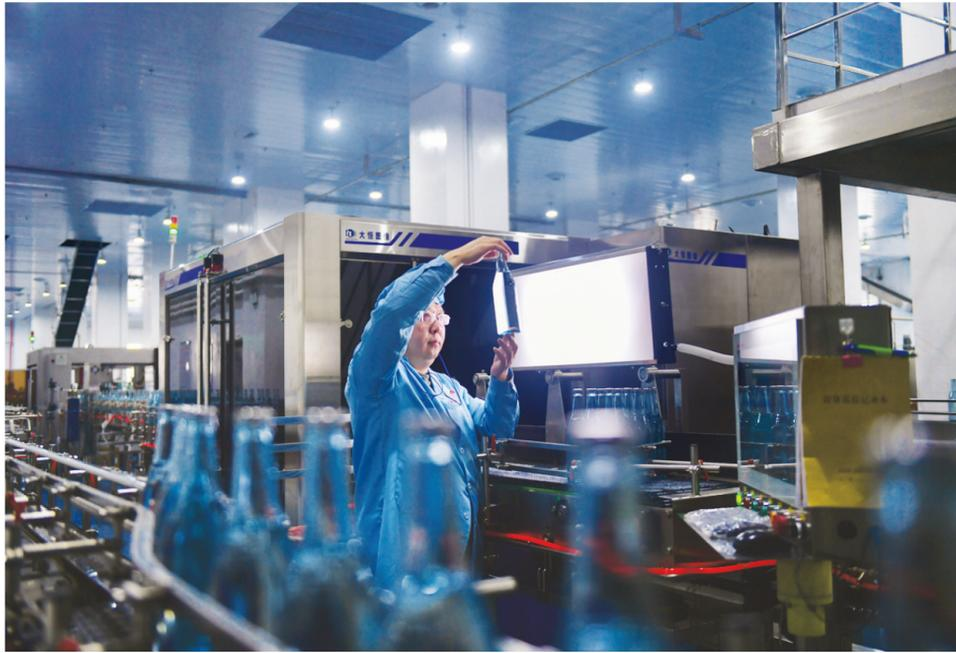
5月2日,太原酒厂工作人员正在对酒液进行质检。该厂重视新技术运用,利用5G+机器视觉技术,将酒液AI质检设备安装安装在酒类灌装线上,大大提升了质检效率,保证了产品质量。米国伟 摄
