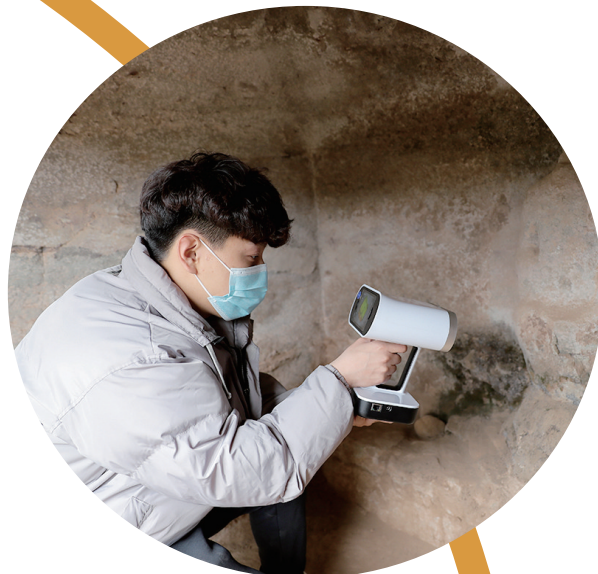
采集人员使用 Artec Leo 扫描仪进行点云数据采集。
