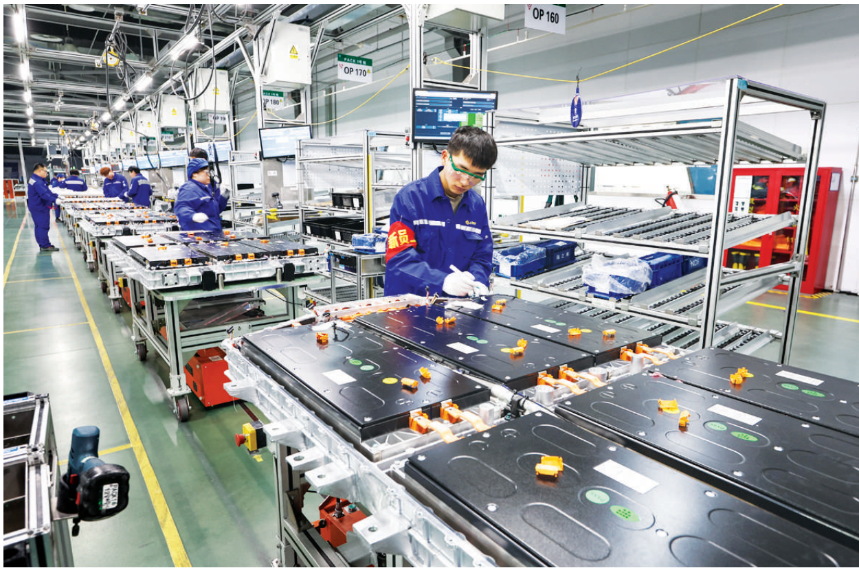
在上汽时代动力电池系统有限公司车间，工人在安装新能源汽车动力电池系统(2023年2月16日摄)。 新华社发
