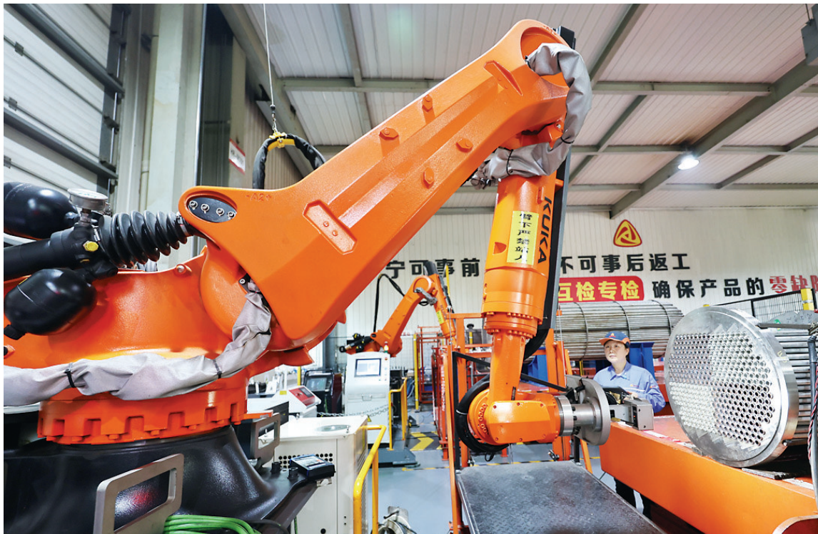
七月二十三日，潞安化工机械集团有限公司，工作人员优化管板机器人数控程序，实现高效、精准的管头焊接作业。王昕、陈阳、摄影报道
