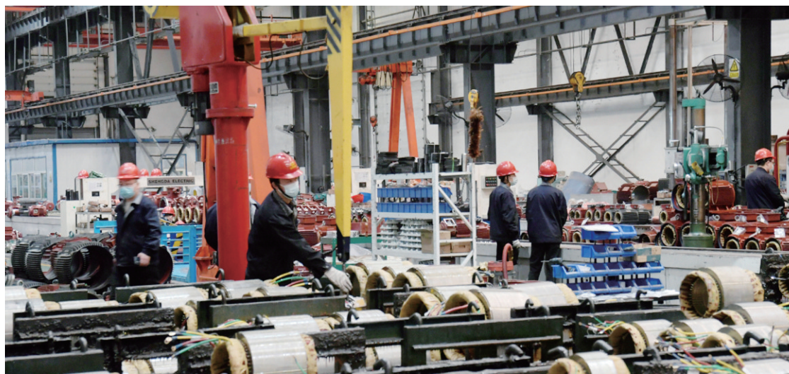
山西电机制造有限公司专门为地铁1号线自主研发了YE5系列烟道用三相异步电动机。 李学军 摄
