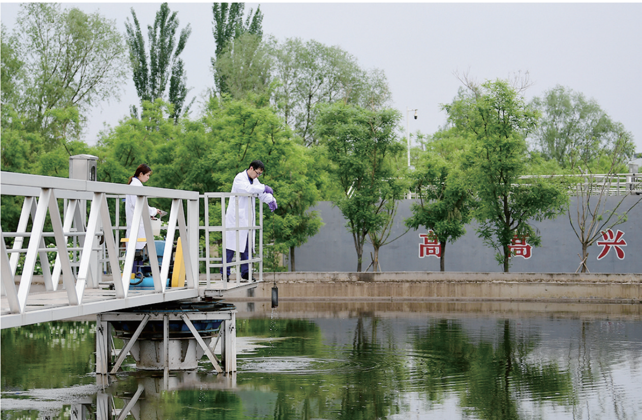
8月21日,太原市城市排水管理中心汾东污水处理厂内,工作人员正在提取水样并进行日常水质项目化学检验工作。近年来,太原污水处理标准不断提高,引进设备,增加处理工序,每日有80多万吨的达标尾水排入汾河,为改善汾河生态环境奠定基础,努力实现“一泓清水入黄河”。米国伟 耿婧媛 摄影报道
