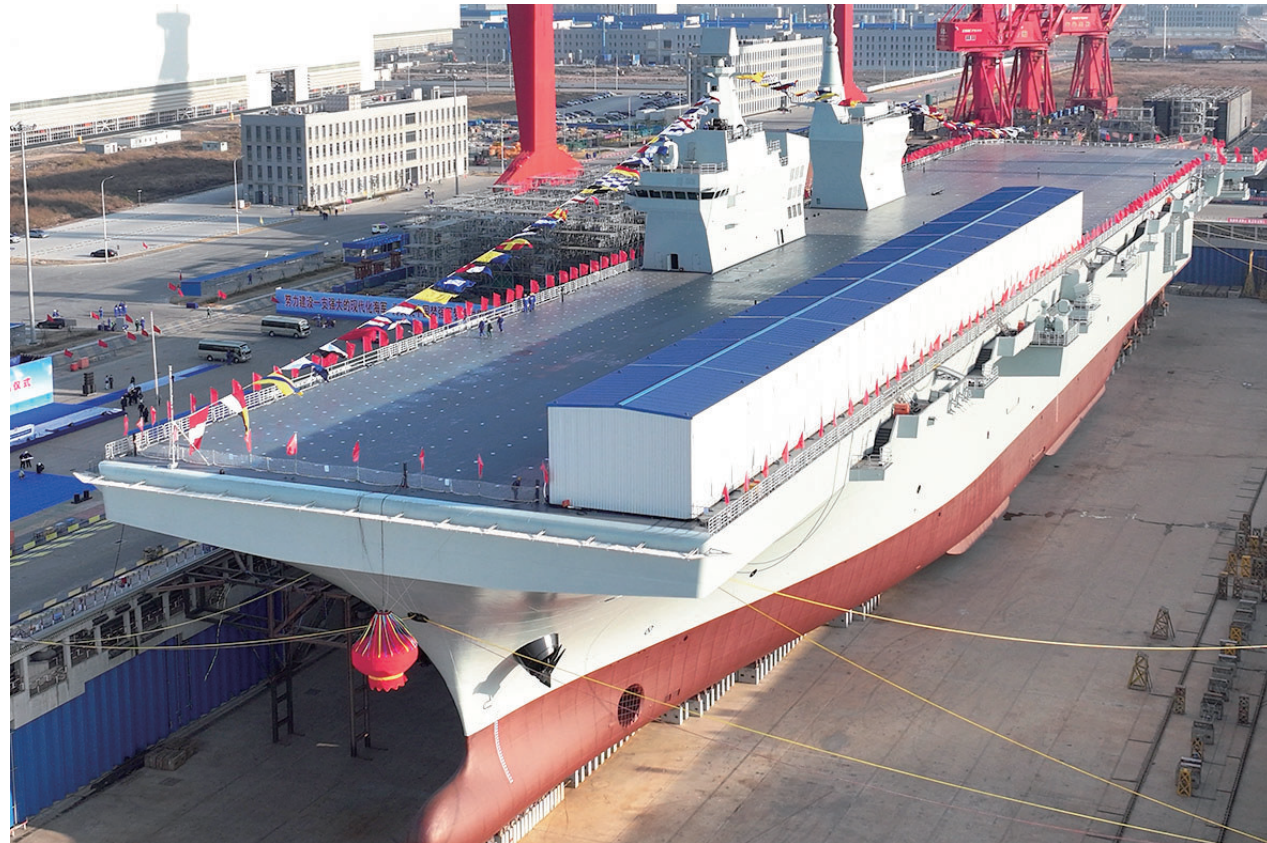
12月27日上午，我国自主研制建造的076两栖攻击舰首舰下水命名仪式在上海举行。经中央军委批准，076两栖攻击舰首舰命名为“中国人民解放军海军四川舰”，舷号为“51”。四川舰满载排水量4万余吨，设置双舰岛式上层建筑和全纵通飞行甲板，创新应用了电磁弹射和阻拦技术，可搭载固定翼飞机、直升机、两栖装备等，是海军新一代两栖攻击舰，是推进海军转型建设发展、提升远海作战能力的关键装备。该舰下水后，将按计划开展设备调试、系泊试验、航行试验等工作。
