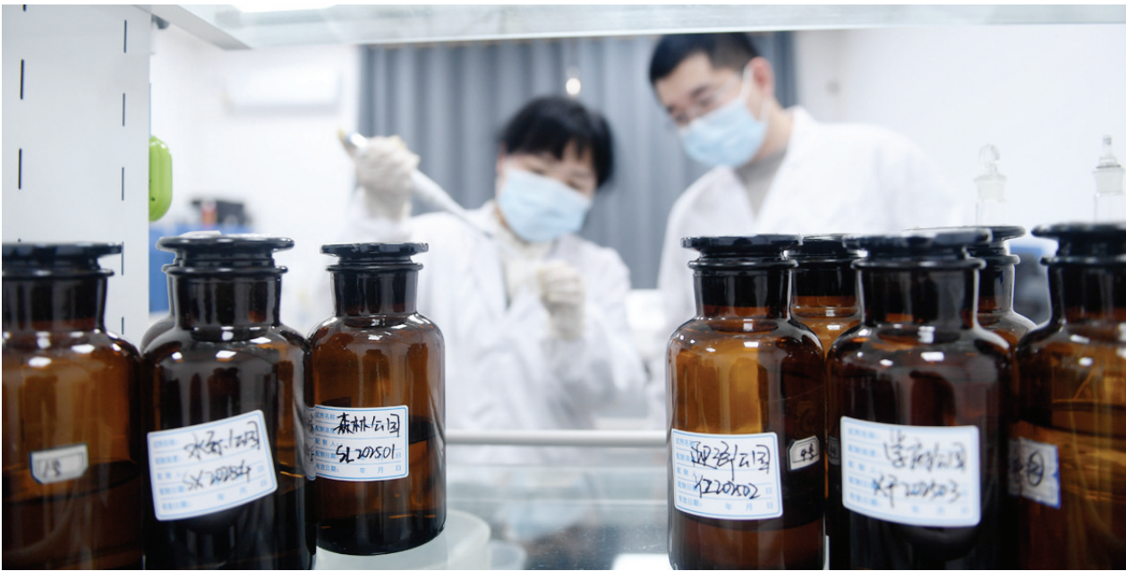
2月18日,太原市园林质量植保站的工作人员正在进行公园景观水体检验工作。入春以来,该站对我市的十余座公园水质开展氨氮、总磷、色度、化学需氧量等12个指标检验工作,为保证公园水质提供数据支持。
