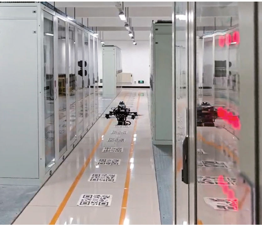
室内无人机在变电站内自主巡查
