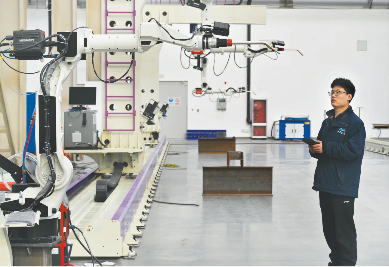
3月28日,山西中北汇科智能装备有限公司生产车间,工作人员正在对XB系列(9轴)机器人焊接工作站进行调试。据了解,该工作站无需人工引导,通过机器人逆向建模即可自动生成焊缝并匹配焊接工艺,实现自动焊接。郭苑甫 摄
