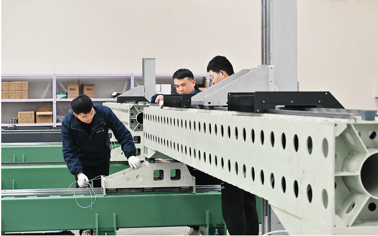
5月8日,山西中北汇科智能装备有限公司生产车间,工作人员正在调试即将出厂的五轴三合一切削设备。该设备具备精度高、切割质量稳定的特点,生产效率较传统等离子切割机提升300%。
