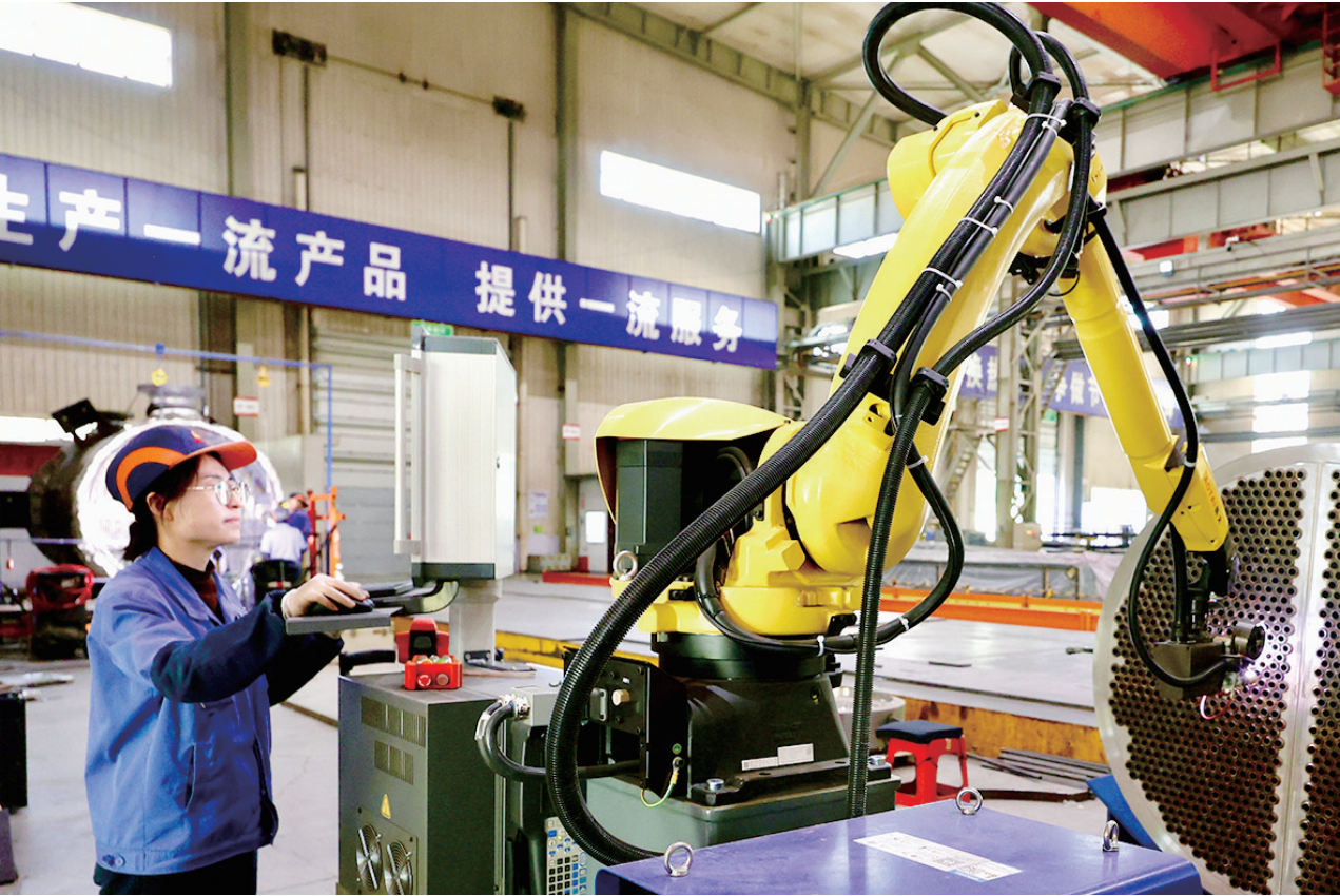
近日，潞安化工机械（集团）有限公司高效换热分公司引进全自动管子管板焊接机器人，加快建设“灯塔工厂”。该机器人可以极大节省工件来回吊运的时间，降低安全风险，减少吊运资源浪费。图为5月28日，焊接人员正在操作机器人。
