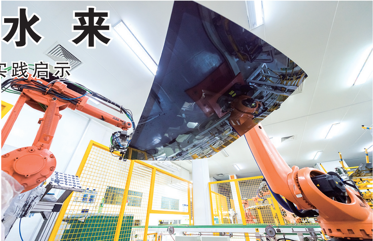
机械臂在福耀汽车玻璃智能工厂的车间生产玻璃产品（二〇二四年四月二十九日报）。新华社发
