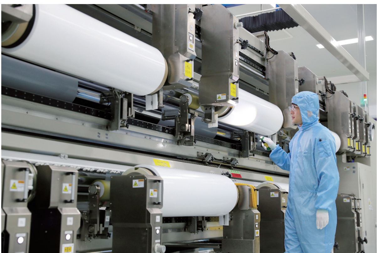
山西厚生新材料科技有限公司大分切员工在分切机运行收卷过程中,使用强光手电筒对产品膜面进行巡检。
