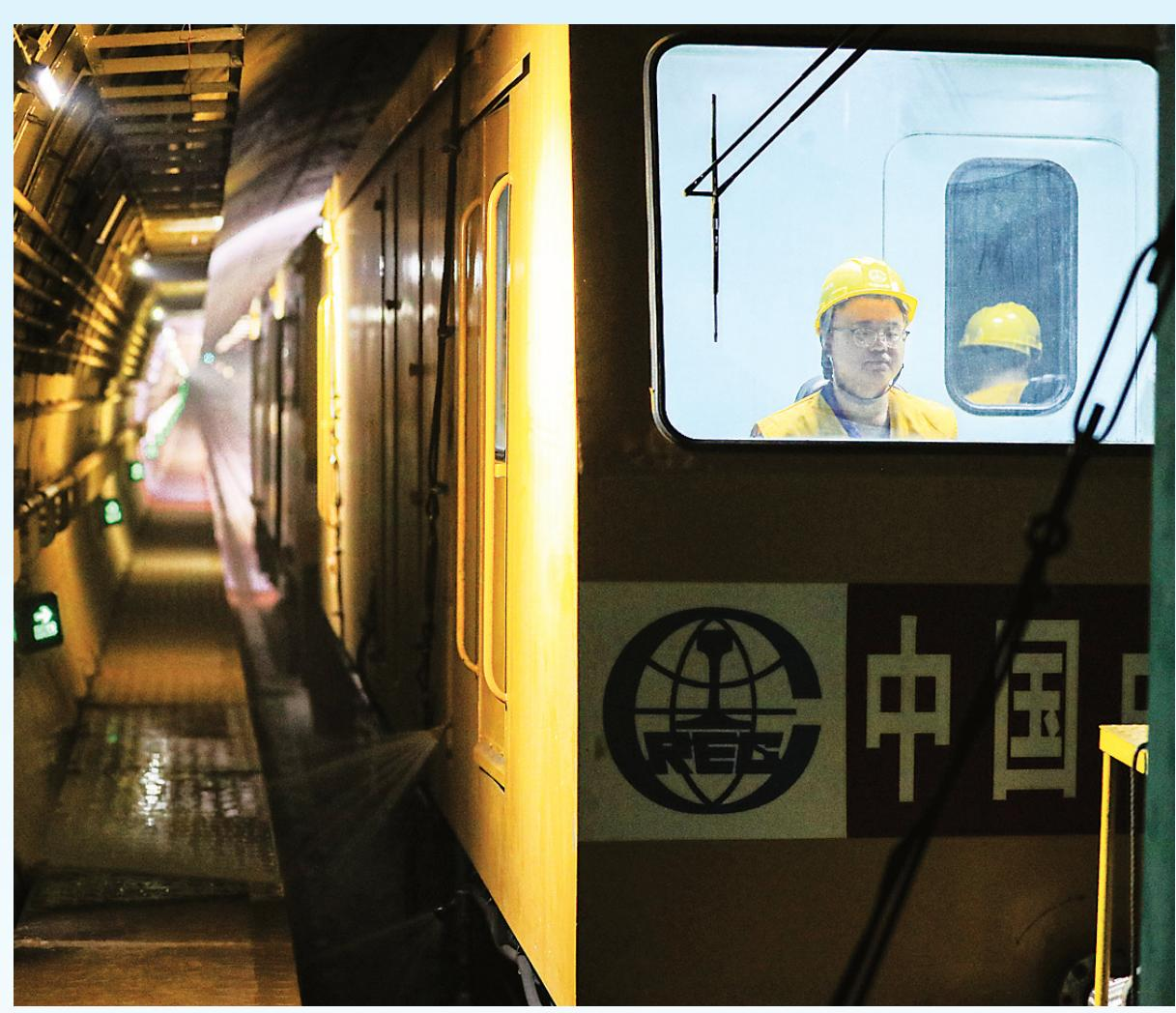
8月12日凌晨,“添翼隧道冲洗车”在2号线开展隧道精细化清洁作业。
