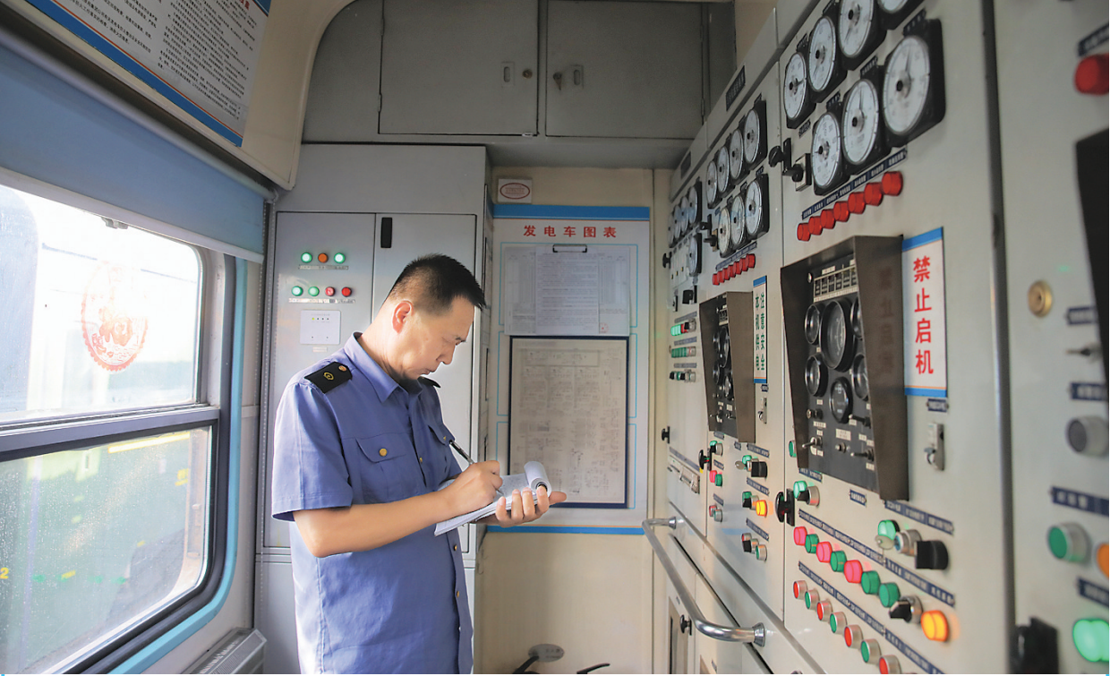
暑运期间，中国铁路太原局太原车辆段全面加强旅客列车的检修。图为8月12日，太原车辆段发电车工作人员正在检查发电车柴油机运转情况。
