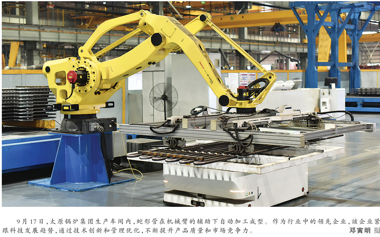
9月17日,太原锅炉集团生产车间内,蛇形管在机械臂的辅助下自动加工成型。作为行业中的领先企业,该企业紧跟科技发展趋势,通过技术创新和管理优化,不断提升产品质量和市场竞争能力。 邓寅明 摄
