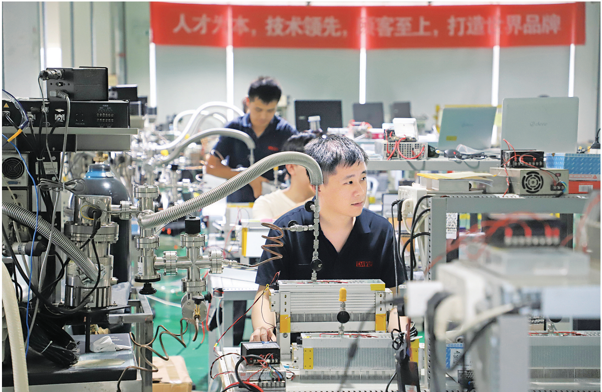
9月19日，山西转型综改示范区大威激光科技有限公司的生产车间内，工人正在组装激光器。近年来，大威激光致力于为各行业提供高性能激光器，推动激光技术在工业、医疗、科研等领域的广泛应用。目前，该公司的射频CO 2 激光器广受市场认可，产品已出口至20多个国家和地区。
