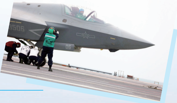
歼-35舰载战斗机在福建舰上电磁弹射起飞前，重量板操作员向飞行员核对弹射重量（资料照片）。
