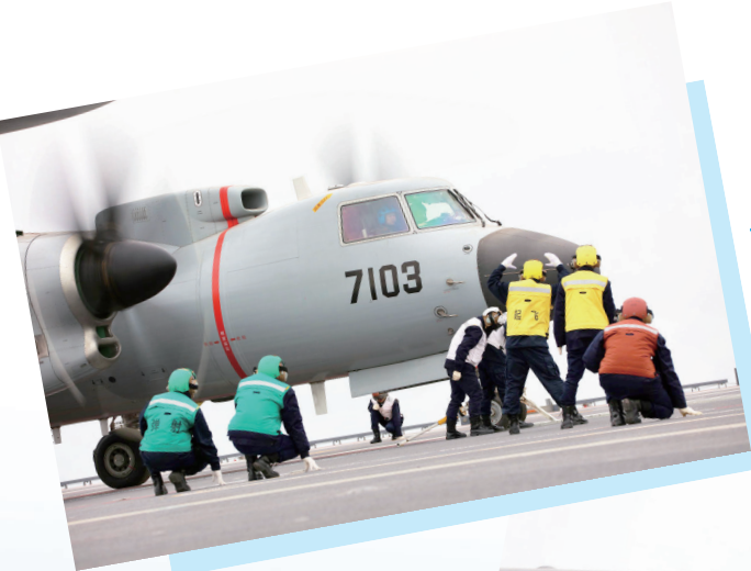
空警-600舰载预警机在福建舰上电磁弹射起飞，放飞小组引导战机弹射入位（资料照片）。
