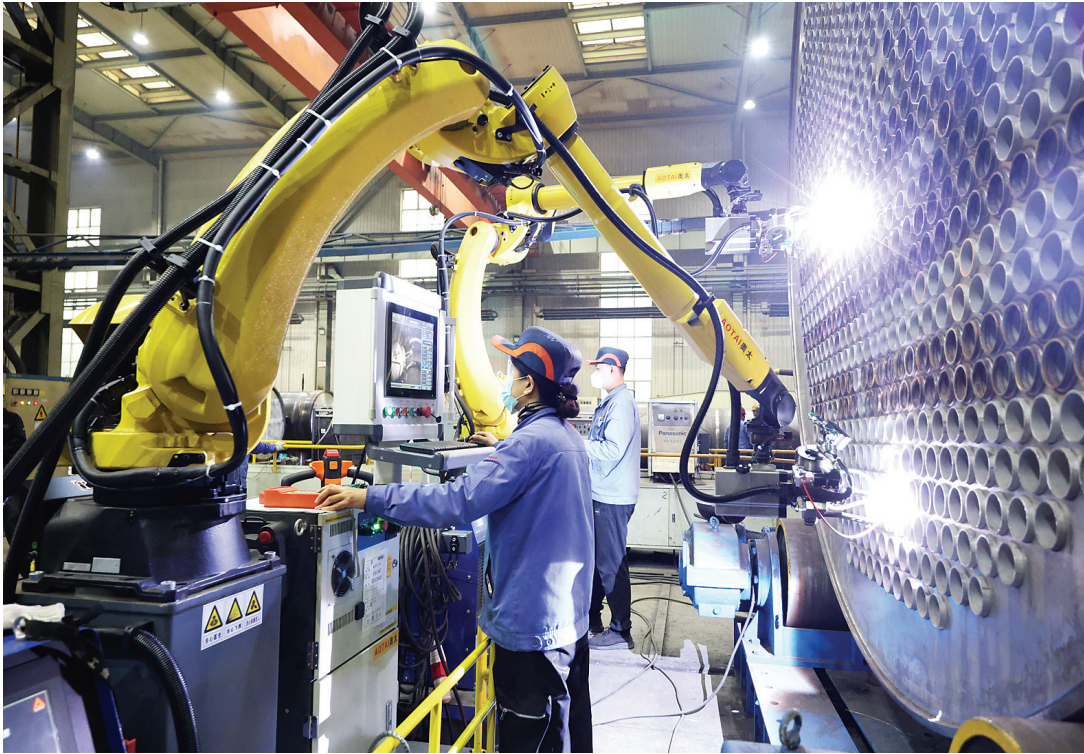
11月6日,潞安化机工作人员操作移动式管子管板智能焊接机器人进行管头焊接工作。近年来,潞安化机始终聚力智能制造,深化精益管理,加大智能单元、智能生产线、智能工厂建设,打造具有全球竞争力的高端能化装备供应商和服务商。
