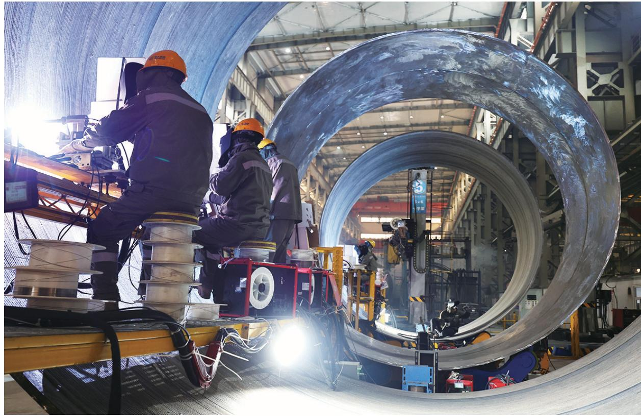
12月20日，潞安化机气化装备分公司一线工人正在对筒体进行熔敷作业。2025年收官在即，潞安化机各生产线工作人员以满格状态向全年生产目标发起最后冲刺，助力潞安化机加快打造具有全球竞争力的高端能化装备供应商和服务商。
