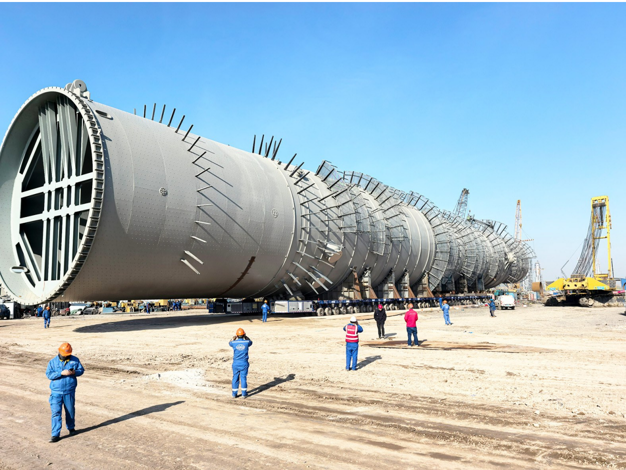
1月6日，由潞安化机承制的全球最大的抽余液塔完成生产制造顺利交付用户。该塔塔体最大直径14.1米，高度122米，最大壁厚140毫米，重量达3700吨。
