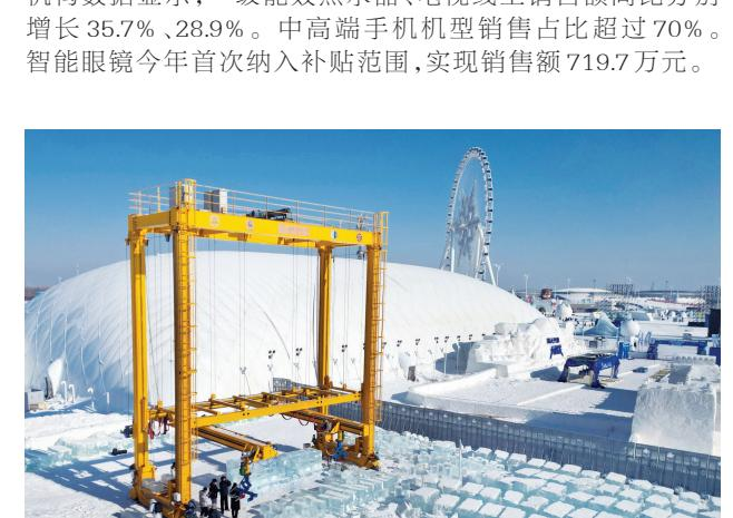
2月3日，在第二十七届哈尔滨冰雪大世界园区，智能大型冰雕自动化搭建机器人进行冰块的提升、搬运与砌筑。2月3日，一款智能大型冰雕自动化搭建机器人在第二十七届哈尔滨冰雪大世界的科技赋能冰雪实验室进入测试阶段。未来，智能大型冰雕自动化搭建机器人将应用于哈尔滨冰雪大世界的建造，打造“冰雪+科技”融合发展新范本。
