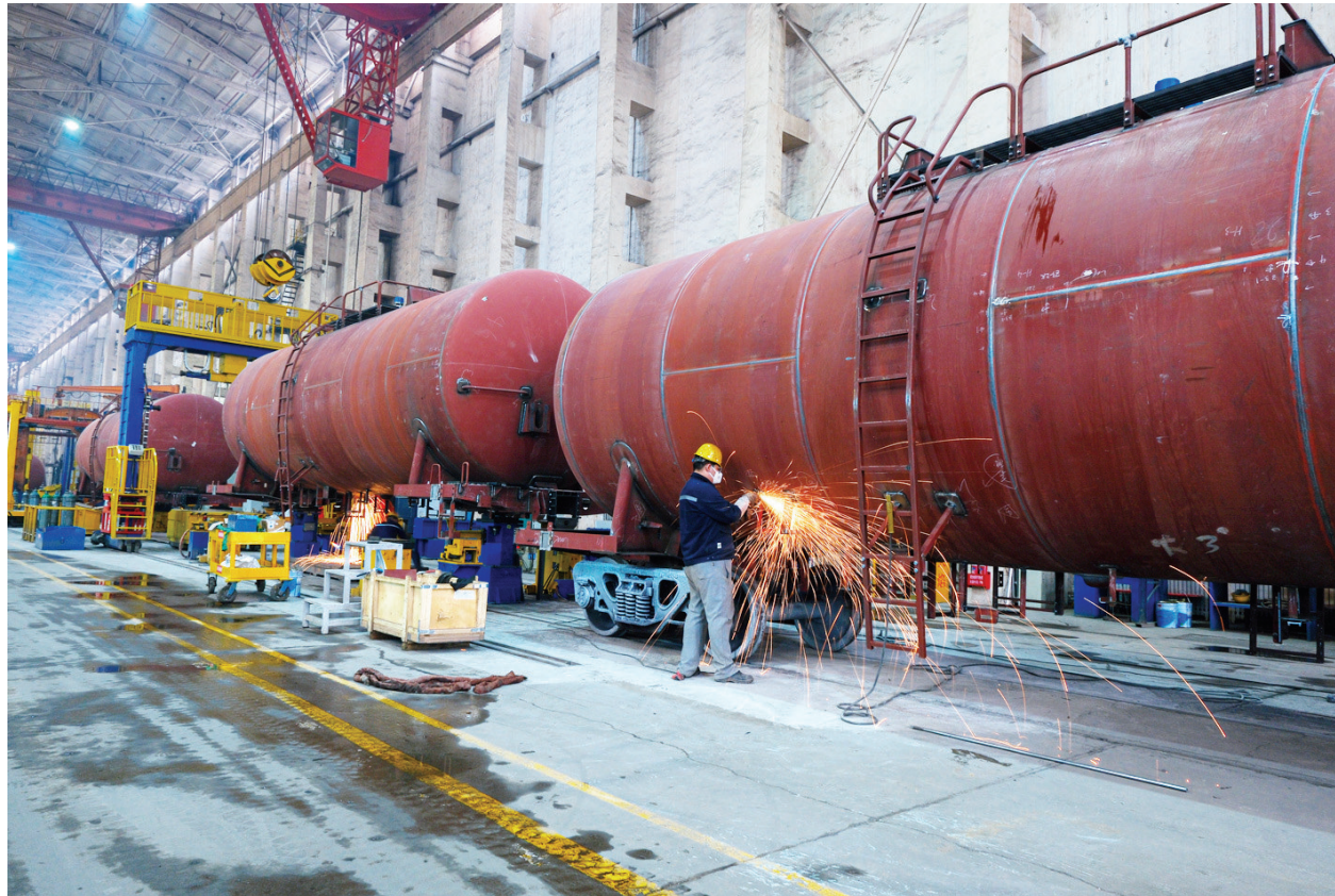
3月22日,晋西车轴铁货分公司完成2026年首季GQ70型轻油罐车生产任务。该公司强化统筹协调,严控关键工序,实现全流程闭环管控,产品一次达标,顺利交付。图为工人对GQ70型轻油罐车焊缝进行精细打磨。王韵菲 摄
