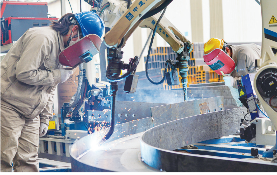
在四川眉山天府新区中建钢构四川有限公司加工车间里，机器人操作人员在观察机器人焊接钢构产品的焊接点(2026年3月23日摄)。新华社发（翁光建 摄）
