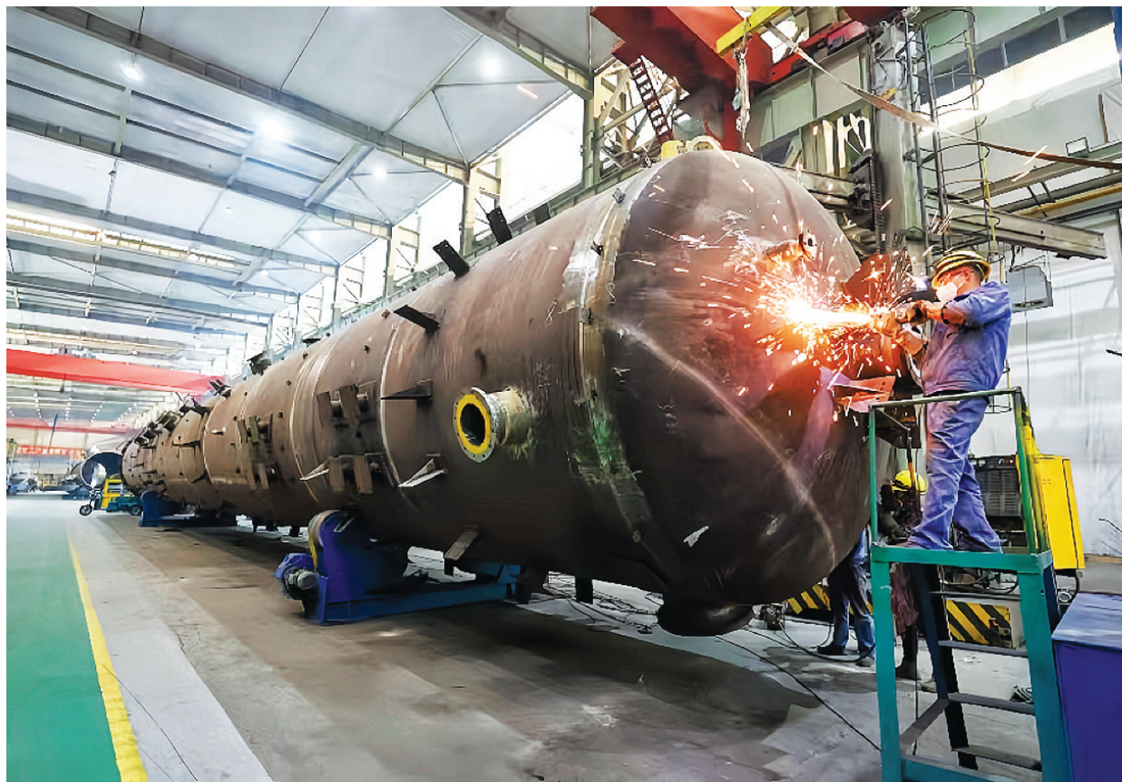
3月25日，潞安化机重型容器分公司铆工正在打磨设备封头。潞安化机加大研发力度，不断提升自身产品的技术含量和附加值，以满足当前煤化工装备市场的多样化需求。王韵菲 陈阳 摄影报道
