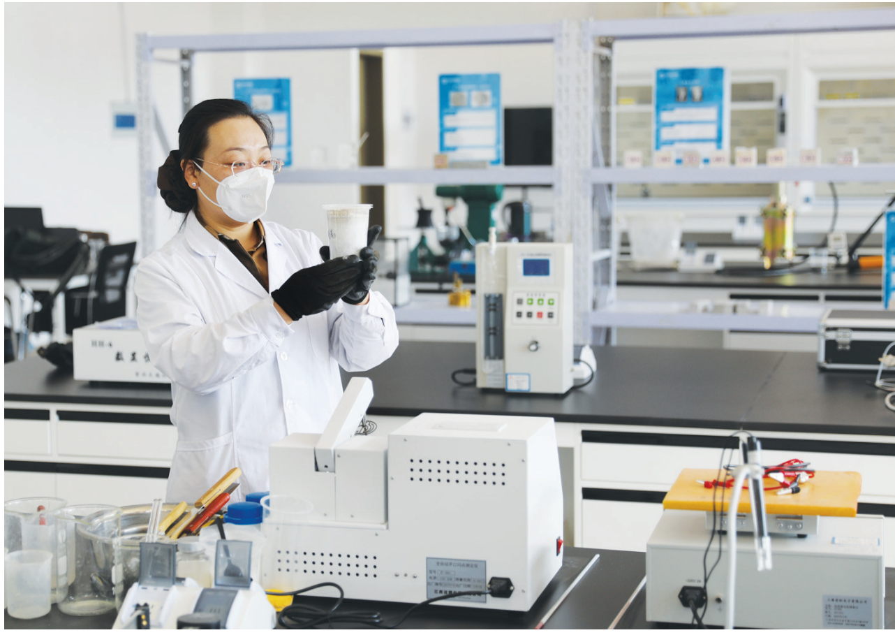
4月8日，山西浩博瑞新材料有限公司的研发人员在实验室对均相型无机粉状材料进行性能测试。该材料以无机矿物为核心基材，采用均相复合改性技术制造，强度高、粘结实、环保阻燃，适配井下低湿高温环境，可快速固结煤岩体，为煤矿安全生产提供绿色可靠的材料支撑。
