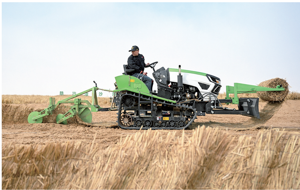
2026年2月28日，工人在内蒙古阿拉善盟境内的乌兰布和沙漠驾驶小型履带式沙障机作业。 新华社记者 贝赫 摄
