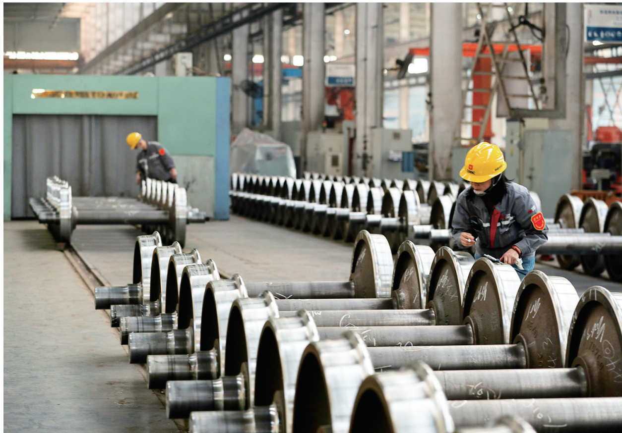
4月25日,中车太原机车车辆有限公司台车车间内,工作人员正在测量铁路货车轮对车轮尺寸。该公司正全力完成500辆C70E型铁路敞车的订单,目前已生产370辆,产量远较去年同期。
